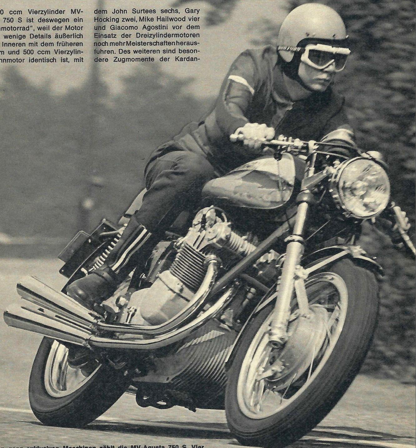
Zu den ganz exklusiven Maschinen zählt die MV-Agusta 750 S. Vier Zylinder, zwei obenliegende Nockenwellen, vier Vergaser, Fünfgang-Getriebe, Kardanantrieb. Identisch mit einer der erfolgreichsten Grand Prix-Maschinen.
