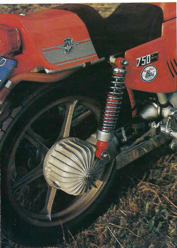
Een bekende verschijning bij deze machines is de dikke bult van de cardantransmissie bij het achterwiel.
